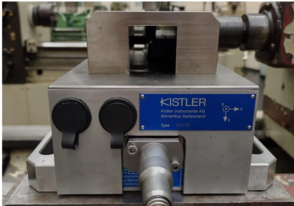
Figura 42: Imagem do dinamômetro usado contendo os vetores de cada componente de força analisada.
